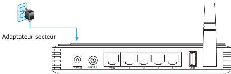
**ÉTAPE 2:** Suivez le schéma ci-dessous pour brancher les appareils en réseau. Les branchements dépendent de vos besoins en matière de connexion, une connexion filaire DSL/Câble, ou modem USB 3G/4G, ou les deux (se servant de connexion de secours l'un l'autre).
