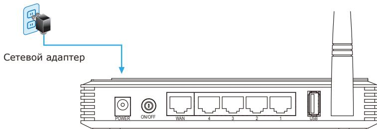
**ШАГ 2:** Подключите сетевые устройства, как показано на рисунке ниже. При необходимости можно установить физическое DSL/кабельное соединение, подключить USB-модем третьего поколения либо оба эти устройства (для взаимного дублирования).
