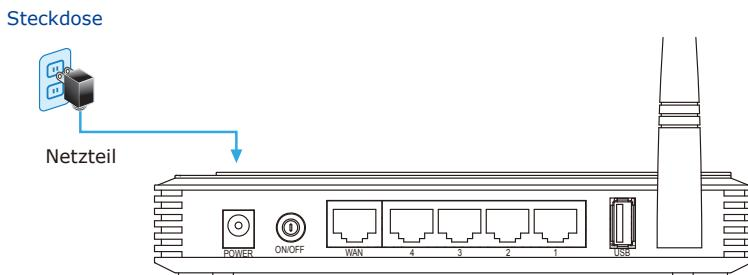
**SCHRITT 2:** Beachten Sie zum Anschließen von Netzwerkgeräten die nachstehende Abbildung. Sie können je nach Bedarf ein DSL/Kabelmodem, ein USB-Modem oder beides (zur gegenseitigen Sicherung) anschließen.
