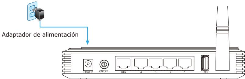
**PASO 2:** Siga la ilustración que se muestra a continuación para conectar los dispositivos de red. Según sus preferencias, puede realizar la conexión cableada con el módem DSL/cablemódem, la conexión con el módem 3G/4G USB o ambas conexiones (como respaldo una de la otra).
