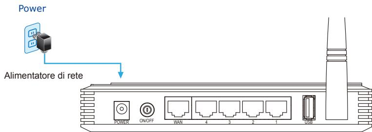
**PASSO 2:** La figura che segue illustra come connettere le apparecchiature di rete. Dipende dalle esigenze se connettere l'ADSL via Cavo, usare il modem 3G/4G USB, oppure contemporaneamente (utilizzando come backup una delle due).
