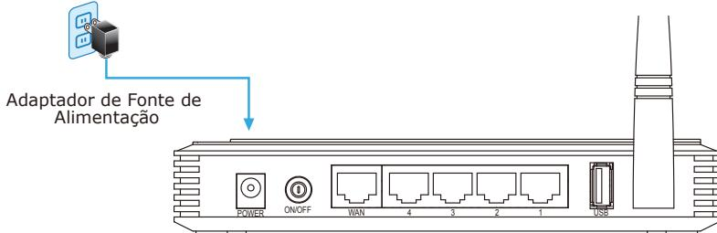
**PASSO 2:** Siga a figura abaixo para conectar os dispositivos de rede. Depende de sua necessidade conectar cabos de conexão DSL/Cabo ou modem USB 3G/4G ou ambos (backup para o outro).
